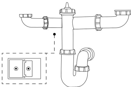
**1** Raccordez le siphon avec l'évier et le tuyau d'évacuation.
