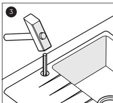
Frappez soigneusement le poinçon avec le marteau. N'utilisez pas de force excessive.
