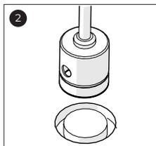
Placez la scie cloche au centre du trou fraisé. Nous recommandons l'utilisation d'une scie cloche diamantée pour béton, grès, etc. d'un diamètre d'environ 35 mm (sans foret pilote).
