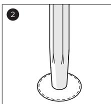
Placez un poinçon rond (diamètre 8-12 mm) au centre de l'autocollant marqué.
